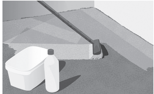
3. ábra: Tisztítsa meg és alapozza le a felületet
