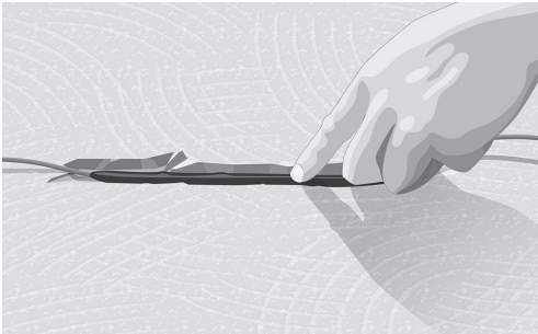
2. ábra: Mélyedés a fűtőkábel és a hidegvég illesztése számára
