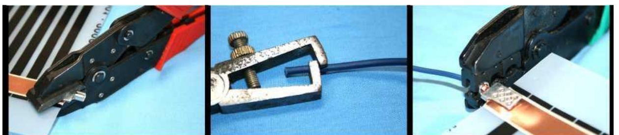
03.2 Ezüst csatlakozó és az elektromos kábel csatlakoztatása
